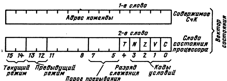
Рис. 9.29. Вектор состояния процессора в малых ЭВМ (СМ-1420, СМ-1300 и др.)
